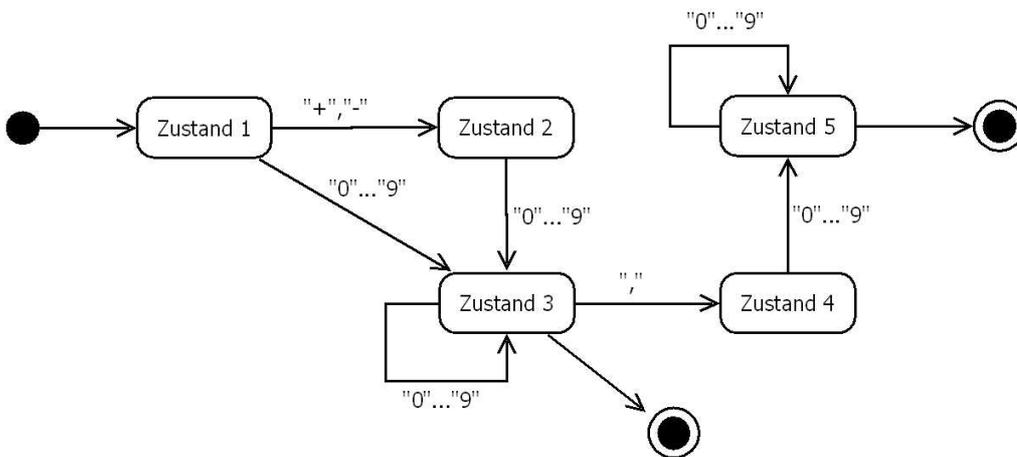
Entwickeln Sie einen Algorithmus (den Sie als Programm umsetzen), um mit obigem Zustandsdiagramm eine Eingabe dahingehend zu prüfen, ob es sich um eine Gleitkommazahl handelt:
